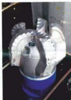
Специалисты компании предложили использовать пятилопастное долото с резами в диаметре 13 мм
