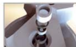
Комбинированная промывка (три боковые и одна центральная насадка)
