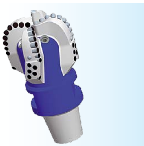
Рис. 1. а) показатели бурения; б) сравнение механических скоростей; в) долото БИТ 215,9 ВТ 416 УСВ.023-01; г) сравнение средних показателей четырехлопастных долот
