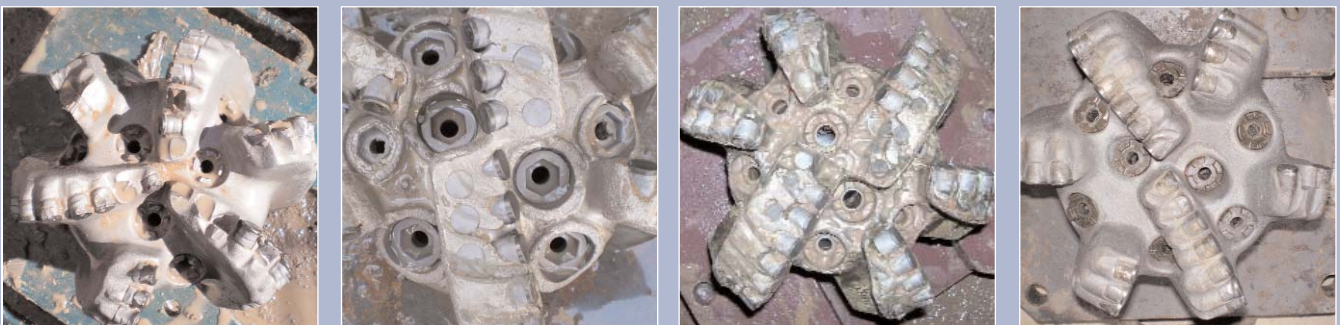
Рис. 3 - износ долот различных производителей.
